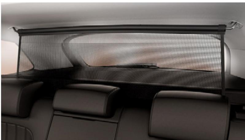
**Suelo de carga variable - Barra de separación
