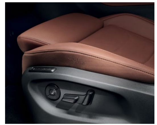
Regulación del asiento: eléctrica y con memoria para el asiento izquierdo y ajuste manual de altura para el derecho
