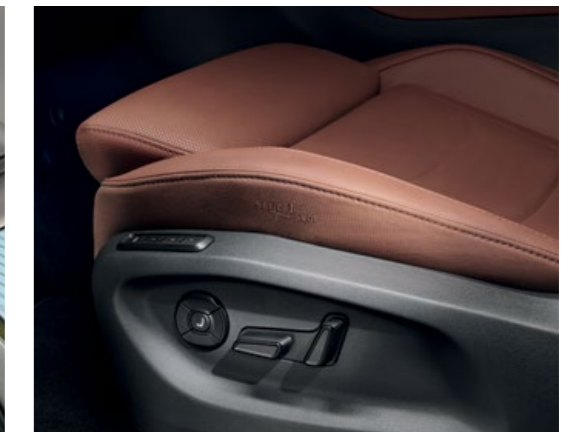
Regulación del asiento: eléctrica y con memoria para el asiento izquierdo y ajuste manual de altura para el derecho
